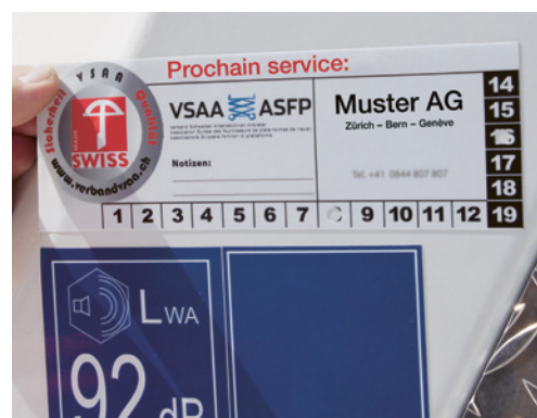
4 La date des prochains travaux de maintenance peut être indiquée sur une plaquette apposée sur l'engin.
